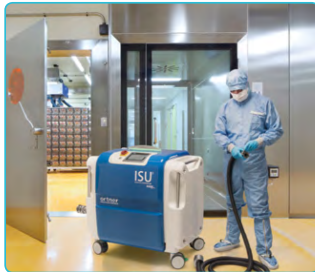
Dekontaminacja pomieszczeń H 2 O 2
